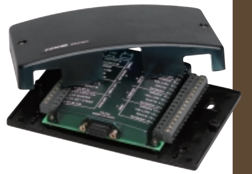
NX2のサーバー本体。ここに各トランスデューサーやGPSからの情報が集まってくる。いわば、システムの心臓ともいえる部分だ
