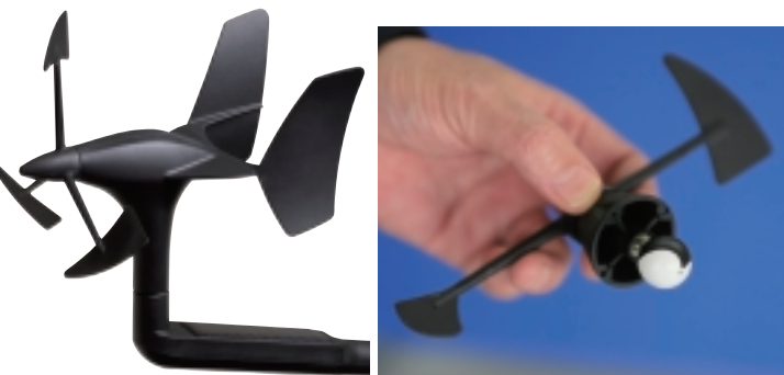
左:NXシリーズに用意されるワイヤレスウインドトランスデューサー(価格:92,400円)。マスト内への配線作業が不要になる 右:ウインドトランスデューサーのセンサー部。黒と白の模様が付いた球形の部分が回転することによって、風速を測定している
